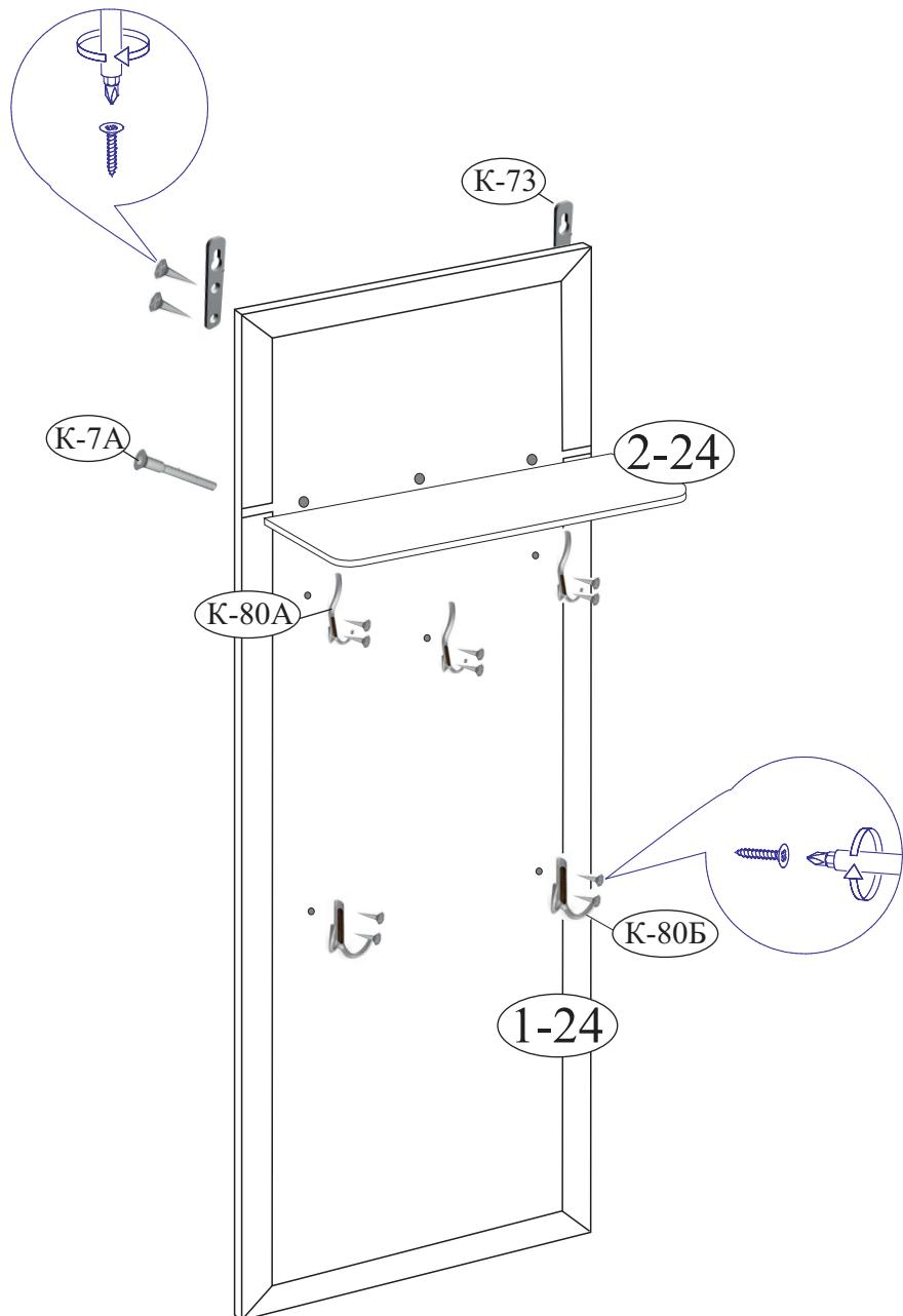
2. Закрепите к стенке вертикальной (поз. 1-24) крючки (К-80А, К-80Б) шурупами 4x16.
