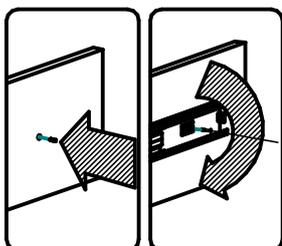
на деталях 03–16 и 04–16 установить внешние части шариковых направляющих
