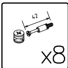
детали 17–16 и 15–15 соединить на стяжку эксцентриковую
