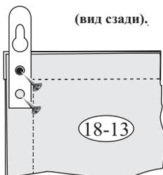
**Крепление стенки задней на (K-45).**
