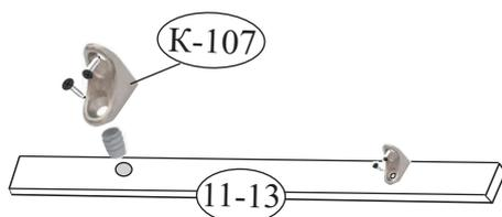
7. Деталь (11-13, 12-13) положите необлицованной кромкой на колпак (5-13), совместите отверстия на полкодержателе (К-107) с отверстиями на колпаке и закрутите шурупы 3,5x16 (между деталями 11-13 и 12-13 должно быть расстояние 16мм для установки перегородки 3-13).
