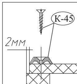
**Крепление стенки задней на (K-59).**
