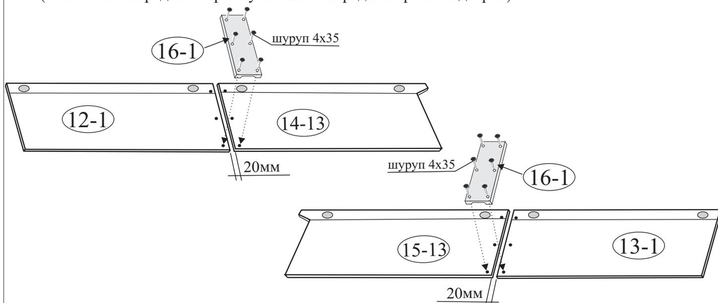
22. Установите петлю (К-17д) на двери (12-1, 14-13), для выравнивания петель перпендикулярно кромки фасада необходимо использовать длинную линейку или прямую планку от жесткой упаковки (прямую деталь каркаса) прижав плотно ее к прямым частям двух соседних петель параллельно кромки фасада.
