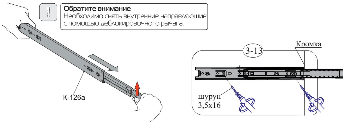
6. Осторожно забейте футорки (К-107) в отверстия на детали (11-13, 12-13), закрепите полкодержатель (К-107) шурупами 3,5x16, прижав вплотную к краю детали.
